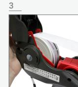
Coloque el rollo de etiquetas entre los sujetadores | Place the label roll between the fasteners | Coloque o rolo de etiqueta entre os fixadores.
