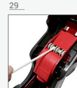
Con ayuda de un hisopo y disolvente, límpie la superficie y rodamientos en los que se observe resto de adhesivo | Rub a swab with solvent onto surfaces and bearings where adhesive remnants are observed | Com a ajuda de um cotonete e solvente, limpe a superfície e os rolamentos onde se observem restos de adesivo.
