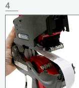
Centre el liner sobre la barra de suministro | Center the liner over the supply bar | Puxe a extremidade do rolo e centre-o na barra de alimentação.
