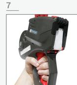
Presione y suelte el gatillo varias veces hasta lograr tensionar el liner. El extremo del liner deberá emerger por la ranura de salida | Pull and release the trigger several times until the liner is stretched out. The end of the liner should emerge from the back output | Pressione e solte o gatilho repetidamente até tensionar o liner. A extremidade do liner deve aparecer através da ranhura de saída.
