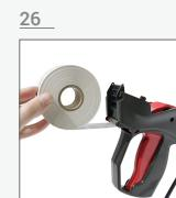
Coloque el rollo a la altura del cilindro gris y corte la cinta en un lugar cercano a este | Place the roll at the same level of the gray cylinder and cut the tape close to the cylinder | Coloque o rolo na altura do cilindro cinza e corte a fita perto do cilindro.
