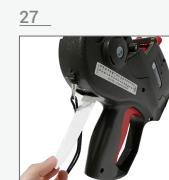
Retire el remanente de liner deslizándolo en dirección opuesta a la etiquetadora | Remove the liner remnant by sliding it in the opposite direction of the labeler | Remova o remanescente deslizando-o na direção oposta da etiquetadora.
