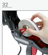
Saque el rollo de etiquetas de entre los sujetadores desplazando el rollo hacia arriba | Remove the roll from the fasteners by moving the roll upward | Remova o rolo de etiqueta dos fixadores movendo o rolo para cima.
