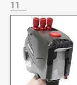
Presione y suelte el gatillo de la etiquetadora las veces necesarias hasta que la etiqueta quede expuesta en la posición de salida | Press and release the trigger of the labeler as many times as needed until the label is exposed in the output position | Pressione e solte o gatilho da rotuladora conforme necessário até que a etiqueta seja exposta na posição de saída.
